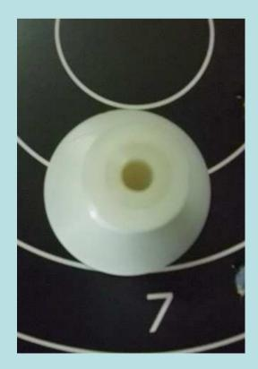
Jaugeage d'un dix avec la jauge universelle à boisseau. Le cordon apparaît, le point est positif.
