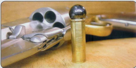
La cavité suit d'assez près le profil de la balle ronde et va déposer au bon endroit un cordon lubrifiant régulier.
