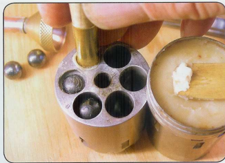
Une petite pression et rotation de l'outil entre les doigts répartit la graisse à la périphérie de la balle.
