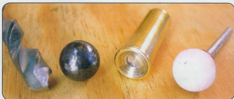
Notre outil de graissage est usiné dans un vieil étui de 38 SP pour former une cavité hémisphérique.
