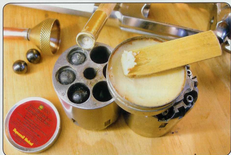
Le barillet est ici présenté démonté pour les besoins de la photo. L'opération de graissage peut être effectuée avec le barillet en place sur l'arme.
