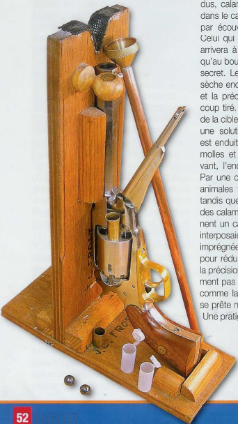
Notre revolver favori Pietta raccourci à 6 pouces est en position de chargement sur son chevalet. On voit en haut l'anneau qui permet de maintenir le drop tube en position.
