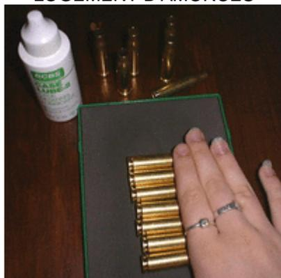
Photo N°2 LUBRIFICATION DES DOUILLES
