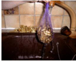
Photo n°1 RINCAGE DES DOUILLES
