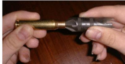
Photo N°3 EBARBER L'INTERIEUR DE LA DOUILLE
