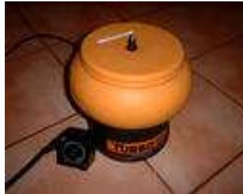
Photo n°3 POLISSAGE DES DOUILLES
