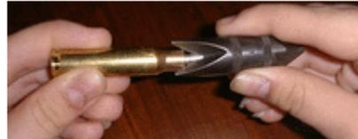
Photo N°4 EBARBER L'EXTERIEUR DE LA DOUILLE
